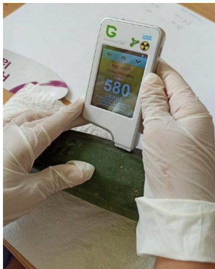
Obr. 3 Testovanie obsahu dusičnanov v zelenine pomocou elektronického merača
