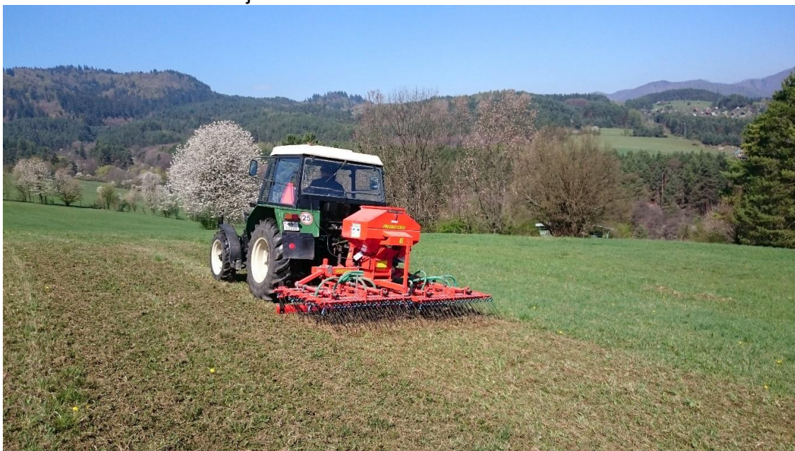
Obrázok 2 Pneumatická sejačka PNEUMATICBOX
