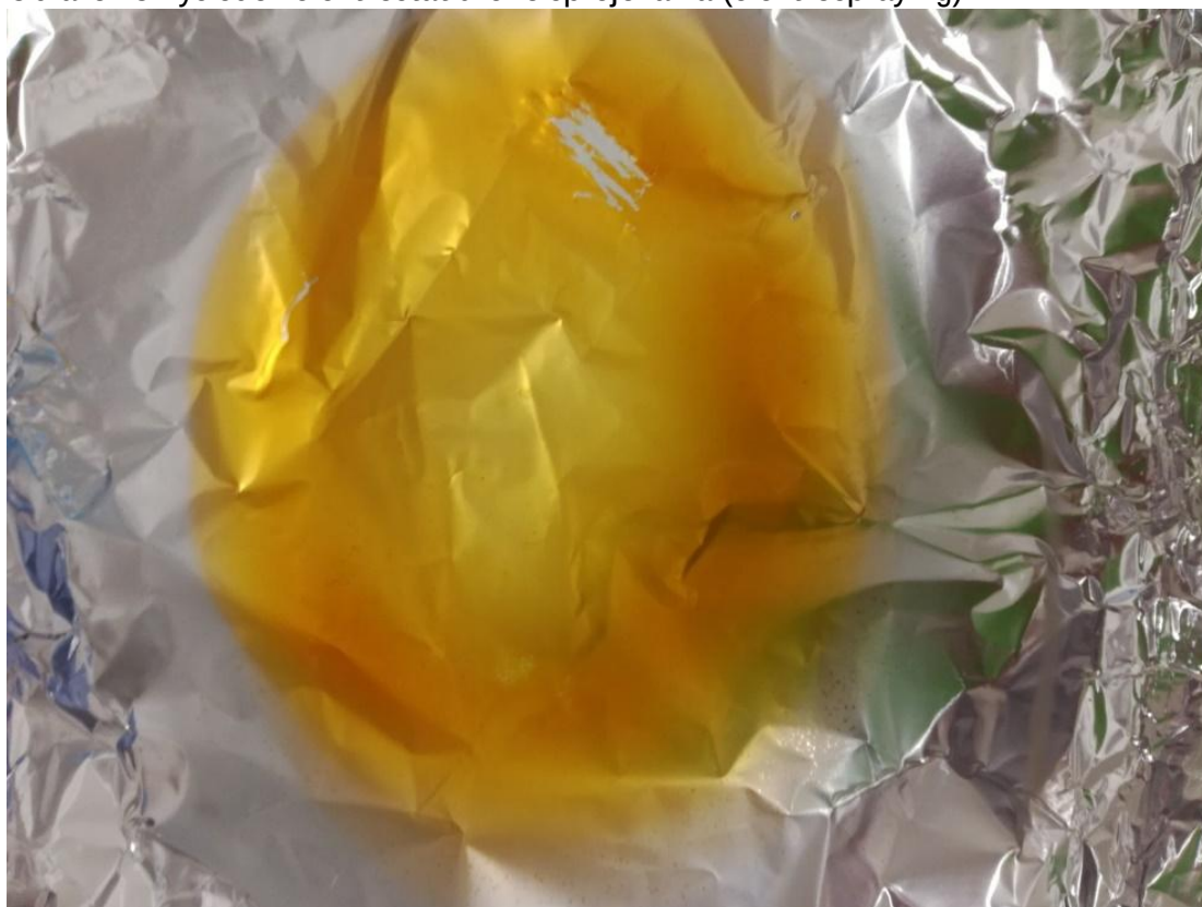
Obrázok 3 Výsledok elektrostatického sprejovania (elektrospraying)
