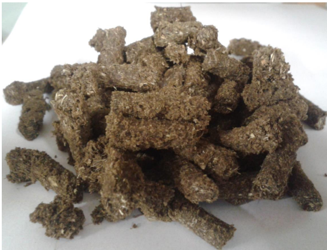
Obr. 4 Metlica trsnatá (vzorka č.1) po 30 s teste odolnosti (WI) proti absorpcii (Foto: Š. Pollák)
