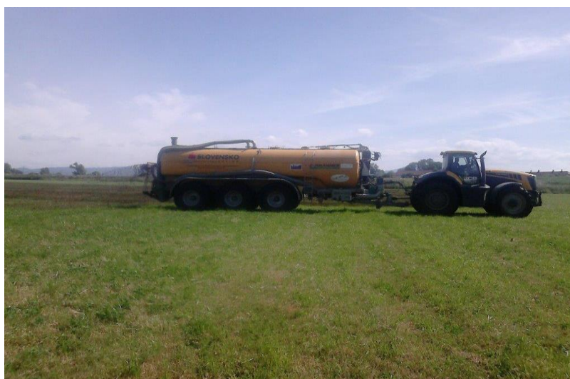
Aplikátor s nízko položenými dýzami na povrch
